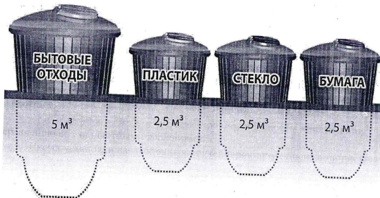
Рисунок 2.3 – Схема установки заглубленных контейнеров
